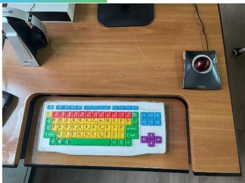
(Беспроводная) Клавиатура адаптированная с крупными кнопками и пластиковой накладкой, разделяющей клавиши
